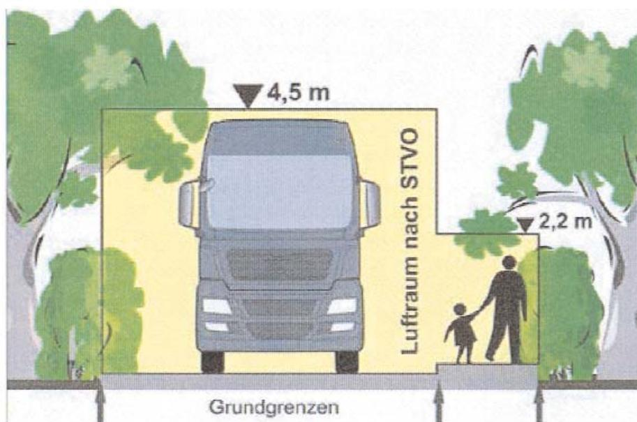
Das Regelprofil umfasst das öffentliche Gut, mindestens jedoch 0,60 m links und rechts vom befestigten Fahrbahnrand und bis zu einer Höhe (senkrecht gemessen) von 4,50 m. Es wird darauf hingewiesen, dass die Gemeinde berechtigt ist, Äste die in den Bereich des Straßenraumes ragen zu entfernen und die Kosten dafür an den jeweiligen Grundbesitzer weiter zu verrechnen.
